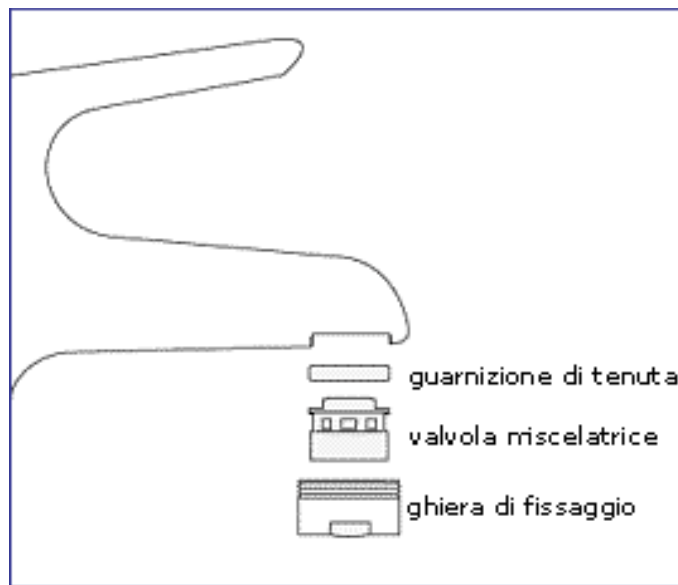
Schema di montaggio del frangigetto
